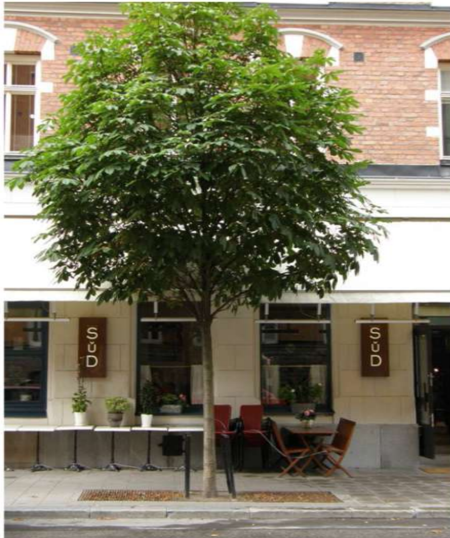
Neuer Strassenbaum in der Swedenborgsgatan in Stockholm. Ältere Bäume sind gegen neue ausgetauscht worden. 15 m 3 verdichtungsbarer Boden/Baum und eine luftige Tragschicht wurden unter die Versiegelung verlegt. (Foto: Björn Embrén)
