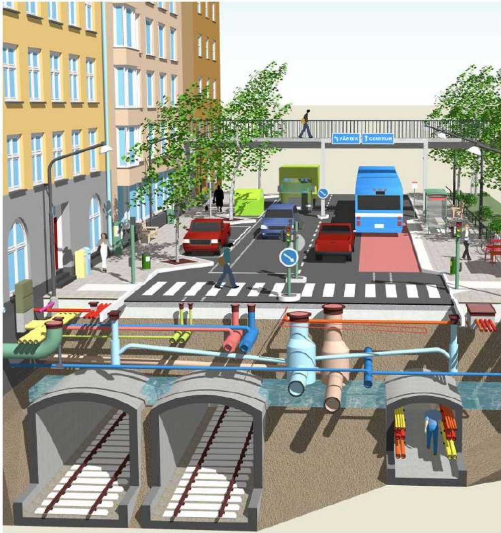
Die Abbildung zeigt den zugänglichen Platz in einer urbanen Situation. Das pflanzzugängliche Volumen für Baumwurzeln ist oft wegen unterirdischer Installationen sehr begrenzt. (Illustration: Per Magnus, Trafikkontoret, Stockholm)
