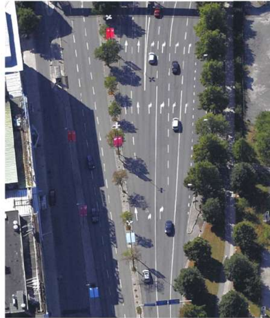
Flugaufnahme von Norrull, Stockholm 2007. Die zur gleichen Zeit gepflanzten Linden haben verschiedene Bodenvoraussetzungen. Die unterschiedliche Entwicklung zwischen Bäumen in versiegelter Fläche gegenüber Bäumen mit Zugang zu Vegetationsfläche ist markant. (Foto: Stadt Stockholm)
