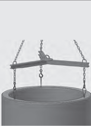
Bauteile mit Seilschlaufen
