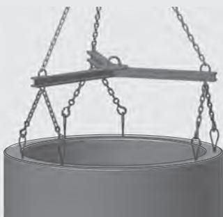
Bauteile mit Doppelanker
