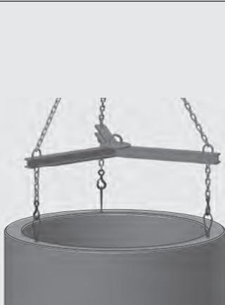
Bauteile mit Seilschlaufen
