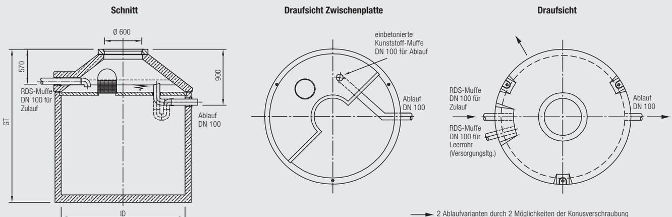
→ 2 Ablaufvarianten durch 2 Möglichkeiten der Konusverschraubung
