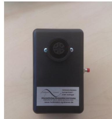
Signaleinheit Rückstau- warnung im Gebäude
