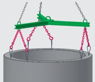
Bauteile mit Versetzankerhülsen
