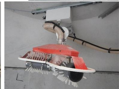
4. Kontrollieren: Der Saugschlauch darf während des Befüllens nicht unter dem Befüll-Stutzen liegen! Kunststoffdeckel verschließen.
