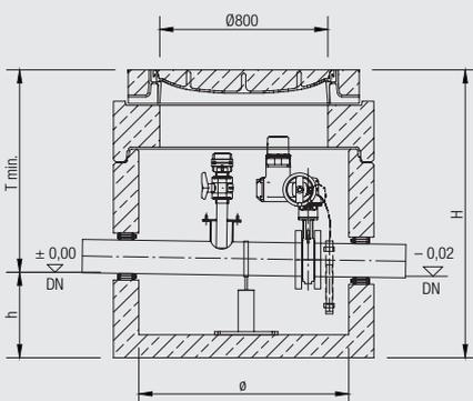
NeutraBloc-A mit Schnellschlussklappe
