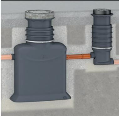
Fettabscheideranlagen werden meistens außerhalb von Gebäuden ins Erdreich eingebaut. Aber es gibt Situationen, in denen aus Gewichtsgründen keine Stahlbetonausführung zum Zuge kommen kann. Mall hat hierzu die Alternative mit dem Fettabscheider NeutraRho Terra aus Kunststoff. Aufgrund des geringen Eigengewichts kann die Anlage mit einem kleinen Hebegerät eingebaut werden.
