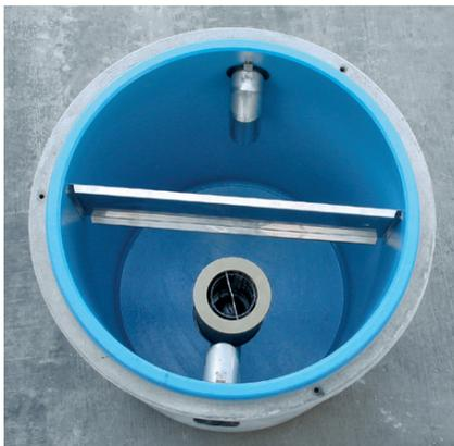
Der Höhenverlust zwischen Zu- und Ablauf beträgt lediglich 20 mm. Aufgrund der geringen Höhendifferenz zwischen Zu- und Ablauf empfehlen wir bei Nachrüstungen den Probennahmeschacht mit Ausführung Mulde.
