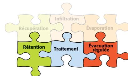
Les bassins de rétention des eaux pluviales sont destinés à l'écrêtement des débits d'eaux pluviales par stockage temporaire. Ils assurent une protection contre les pics de débit (stress hydraulique) dans les eaux superficielles ou les réseaux d'assainissement et permettent une réduction de la section des systèmes d'évacuation.
