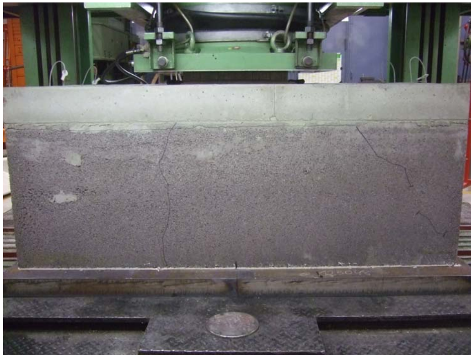
Bild 3: Prüfkörper Nr. 2, Seitenansicht (A) des zerstörten Prüfkörpers nach Durchführung der Prüfung
