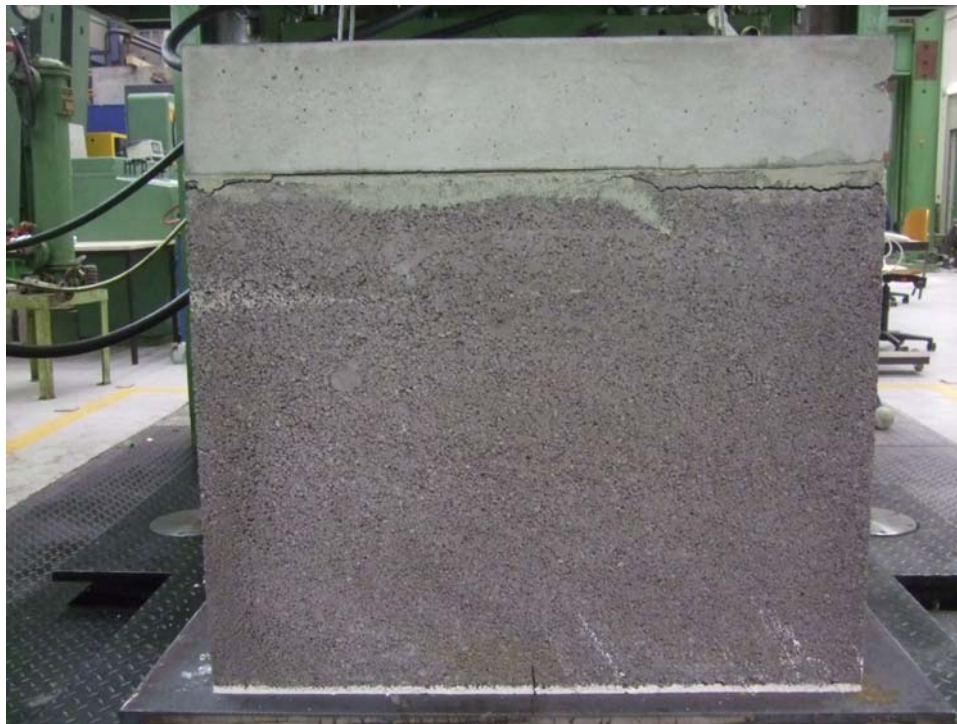
Bild 5: Prüfkörper Nr. 2, Vorderansicht (A) des zerstörten Prüfkörpers nach Durchführung der Prüfung
