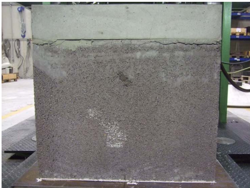
Bild 6: Prüfkörper Nr. 2, Vorderansicht (B) des zerstörten Prüfkörpers nach Durchführung der Prüfung
