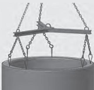
Bauteile mit Doppelanker
