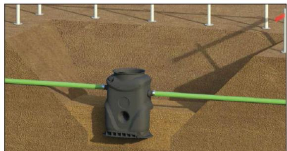
8. → Behälteraufsatz ③ bei Bedarf kürzen.
