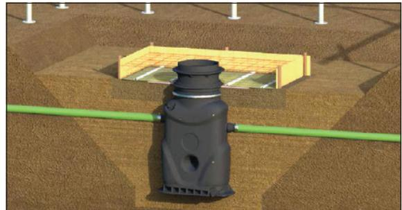
24. → Beton (Betongüte gemäß Bewehrungsplan,
