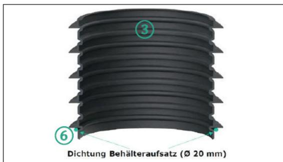
11. → Behälteraufsatz (3) auf Fettabscheider (1) setzen und mit Spannring fixieren.
