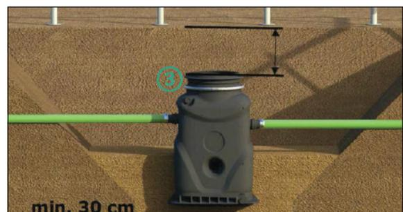
9. → Behälteraufsatz an einer vorgegebenen Stelle ..... mit geeigneter Säge ablängen.
