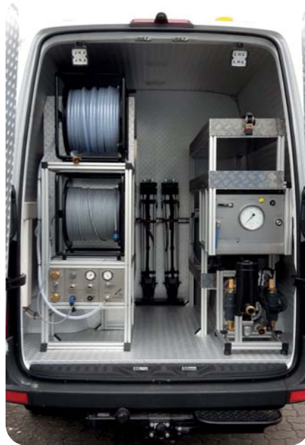
Blick in den Heckausbau eines Dichtheitsprüf- fahrzeugs
